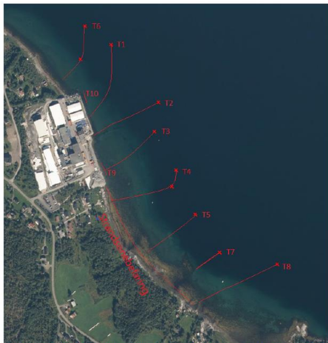
Figur 3. Transekter (T1-8), samt to undersøkelser på grunt vann (T9-10) undersøkt med Blueye ROV, og området hvor det ble foretatt strandsonebefaring i februar 2023 ved anlegget til Quartz Corp AS i Drag, Tysfjord. Posisjoner til T1-8 og strandsonebefaringen er gitt i Tabell 1. Det ble ikke tatt GPS posisjoner for T9-10 fordi man ikke ønsket å kjøre båten inn på grunt vann (<5m). Kartbildet hentet fra GeoNorge.
