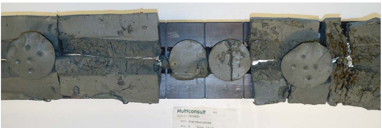
Figur 4-3: Siltig, sandig, leire fra 1,0-1,8 m dybde i BP. 6.
