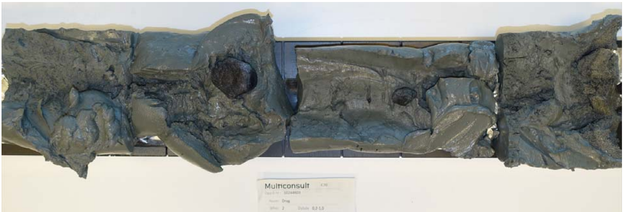
Figur 4-2: Siltig, sandig kvikkleire fra 0,2-1,0 m dybde i BP. 2
