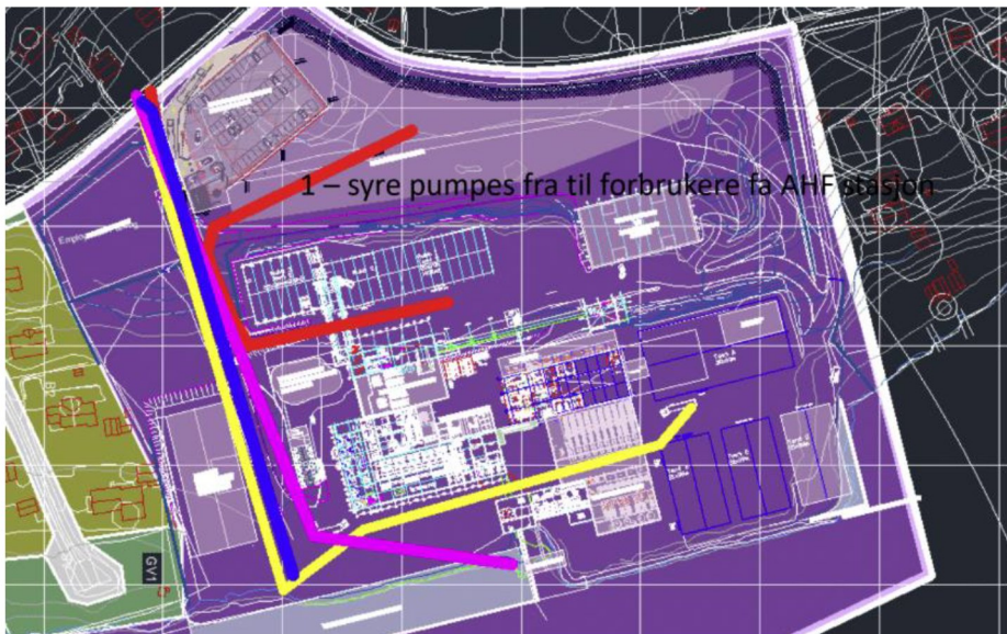
Figur 4-3 0-alternativet. Transportstrømmer innen planområdet. Rosa og røde linjer er transport inn og blå og gule linjer er transport ut
