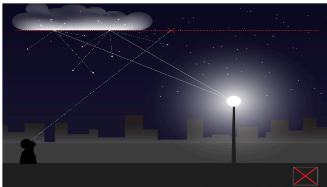
Figur 2. Armaturer uten avskjerming lyser i alle retninger, mye av dette lyset treffer partikler i atmosfæren og bidrar til at stjernehimmelen blir mindre synlig.
