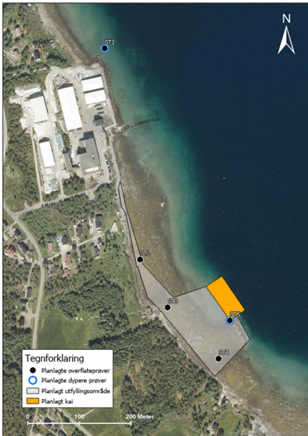
Figur 2-2: Omtrentlig markering av undersøkelsesområdet med prøvestasjoner.
